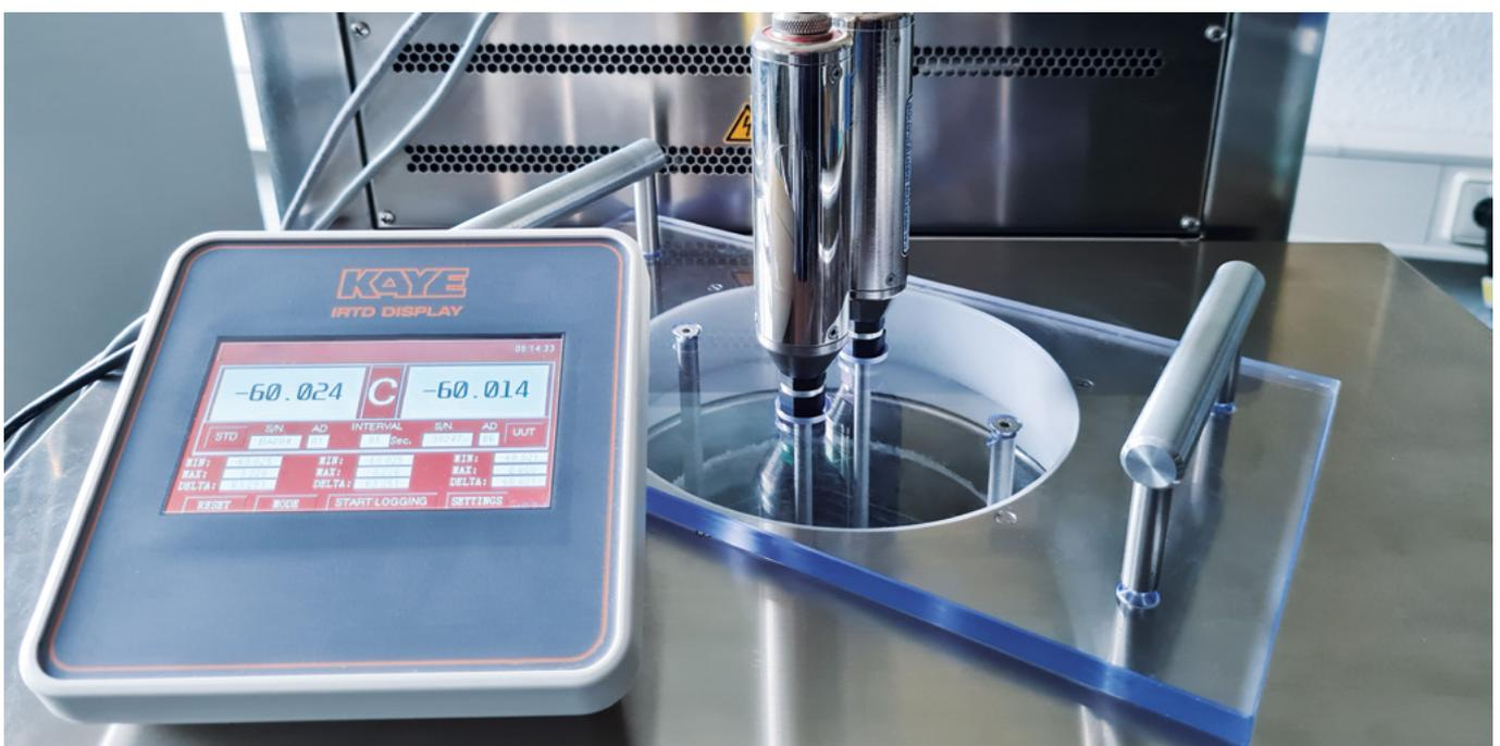
Bild 3: Direkter Vergleich zweier IRTDs durch das IRTD-Display
