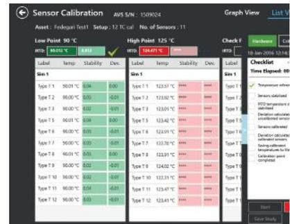
O Console mostra o processo de calibração inteiro na tela. Os campos de dados mudam de cor para mostrar progresso da estabilidade e desvio de cada sensor. Na tela é apresentado o “status”, uma lista de todos os passos e indica onde o sistema se encontra no processo.
